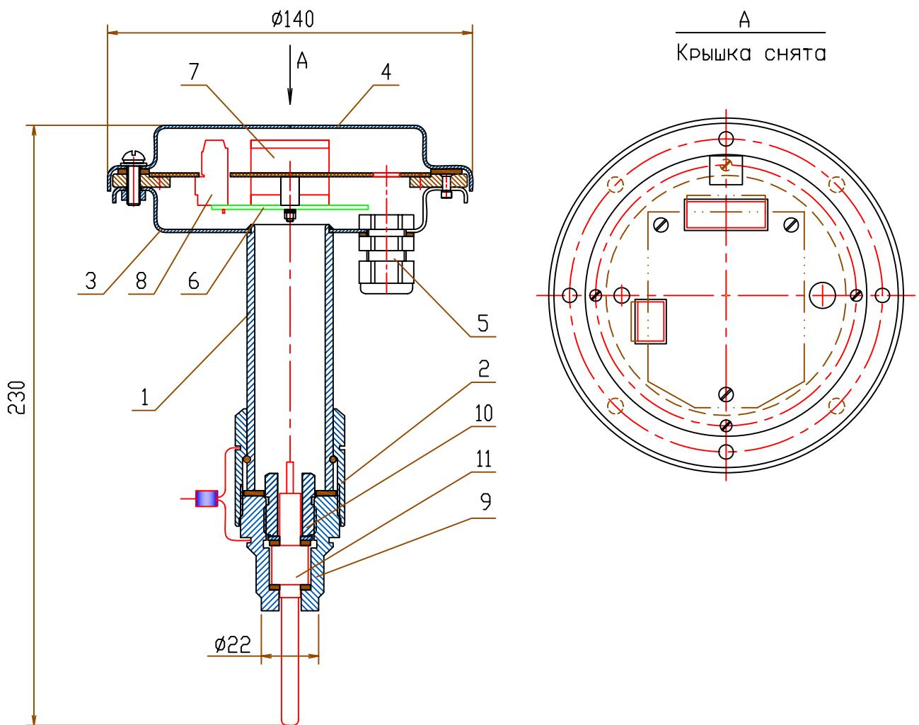
1. Штанга; 2. Накидная гайка; 3. Корпус ДДТ; 4. Крышка СП; 5. Кабельный ввод;
